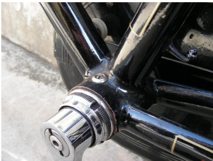
Movimento centrale a doppia campana e oliatore “a doppia vite”. Più dietro, rinvio del filo del cambio (modello da donna) (fonte: SIMOPD)
