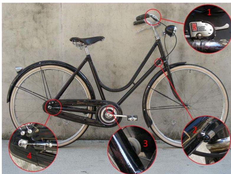
Componenti del cambio nel modello da donna
