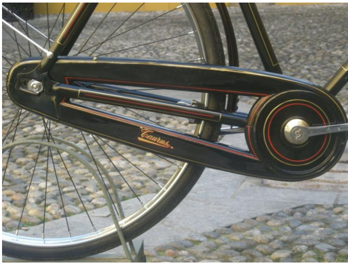
Carter con viti di carico e scarico olio, in questa versione con codino fermato da due viti anziché incernierato (fonte: CARLOA)
