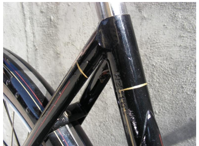
Tubi posteriori “schiacciati” e assenza di bulloni stringisella (parafango di epoca successiva) (fonte: SIMOPD)
