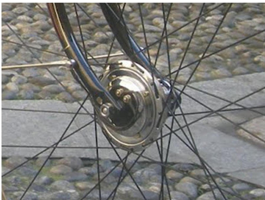
Mozzo anteriore Sturmey Archer Dynohub con dinamo integrata (fonte: CARLOA)
