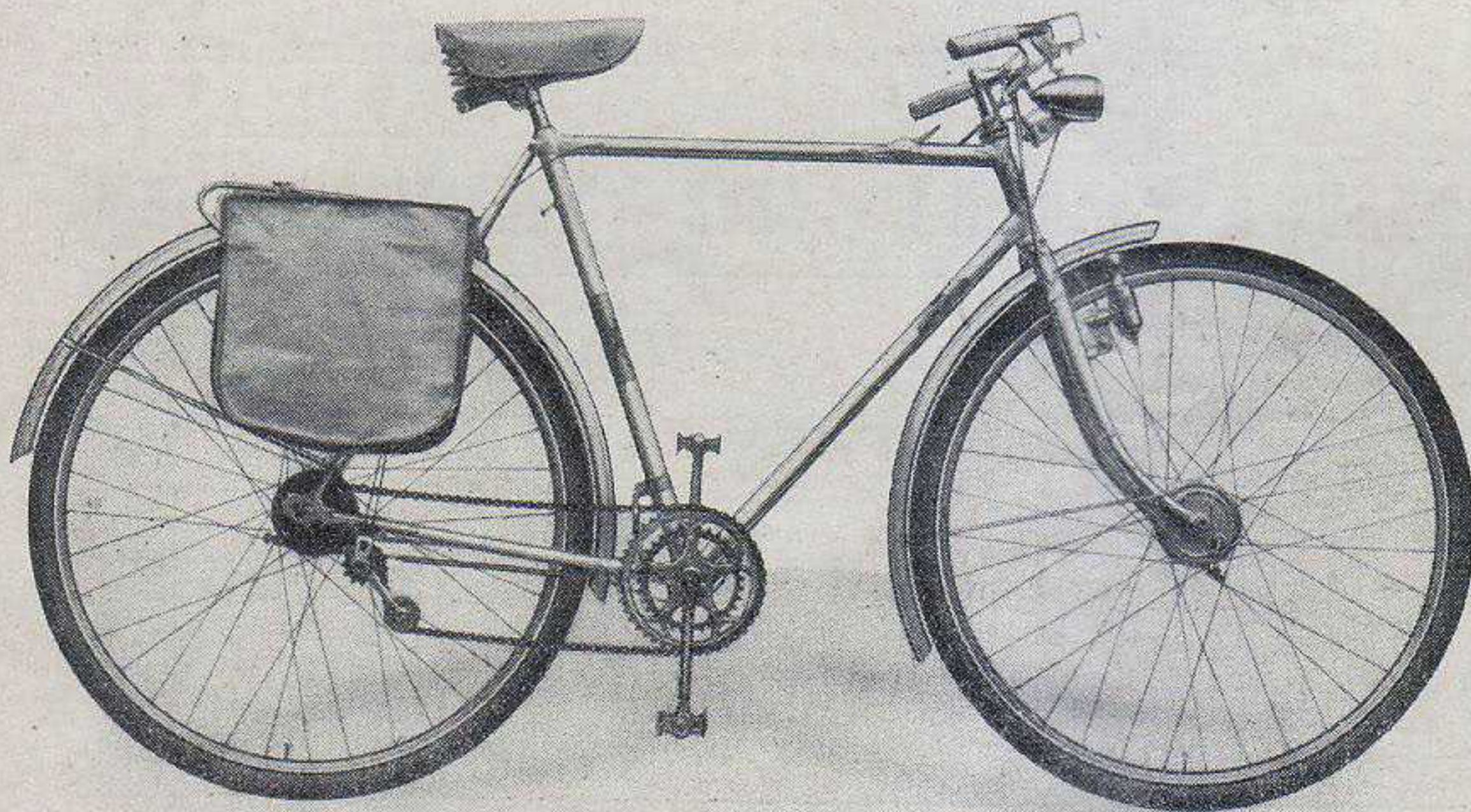
La Dei speciale per cicloturismo, con doppia corona al pedaliere, freni ad espansione e completa attrezzatura per i lunghi viaggi.
